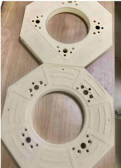
多孔陶瓷同时称之为纳米微孔真空吸盘，是指经过特殊的纳米粉体制造工艺先生产出均匀的实心或者真空球体，通过高温烧结在材料内部生成大量彼此连体或闭合的陶瓷材料，凭借特殊的结构从而具有耐高温、耐磨损、耐化学腐蚀、机械强度高、易于再生和优良的抗热震性等优点，可用于高温过滤材料、催化剂载体、燃料电池的多孔电极、敏感元件、分离膜、生物陶瓷等，在化工、环保、能源、电子、生物化学等领域展现出独特的应用优势。
